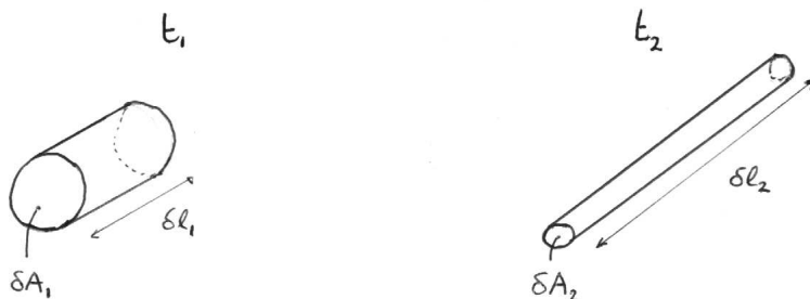
Figuur 3: een stukje wervel buis op t = t_1 en t_2
