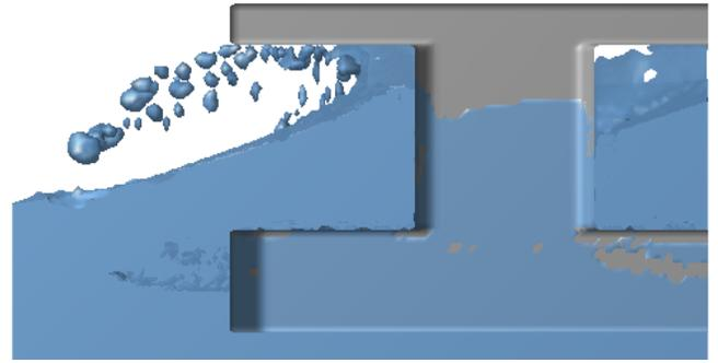
Figure 18. Long wave, the 1<sup>st</sup> column run-up, stage (d)
