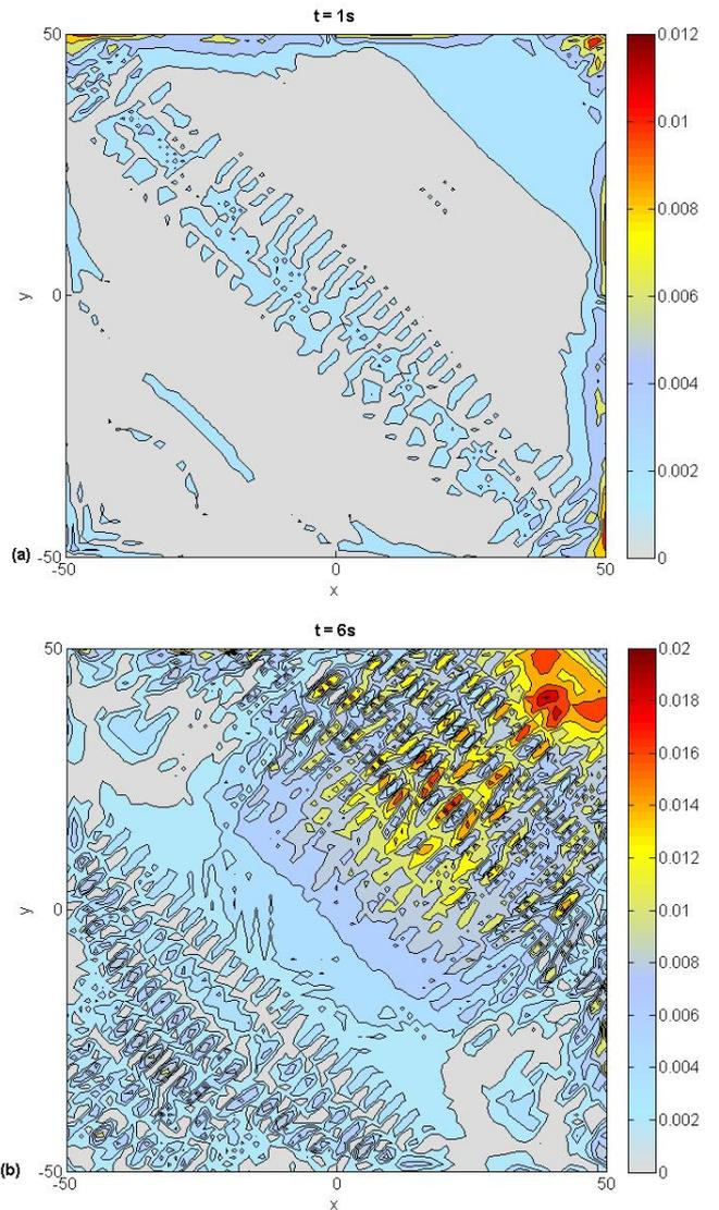
**FIGURE 5.** THE DIFFERENCE BETWEEN THE WAVE ELEVATIONS OF THE NUMERICAL AND THEORETICAL SIMULATION. ERRORS ARE SHOWN AT TIMES: (a)  $t=1s$ , (b)  $t=6s$ .
