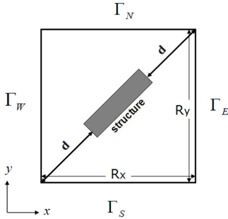
**FIGURE 2.** PARAMETER  $d$  CONTROLS THE DIMENSIONS OF THE COMPUTATIONAL DOMAIN ON THE  $x-y$  PLANE.
