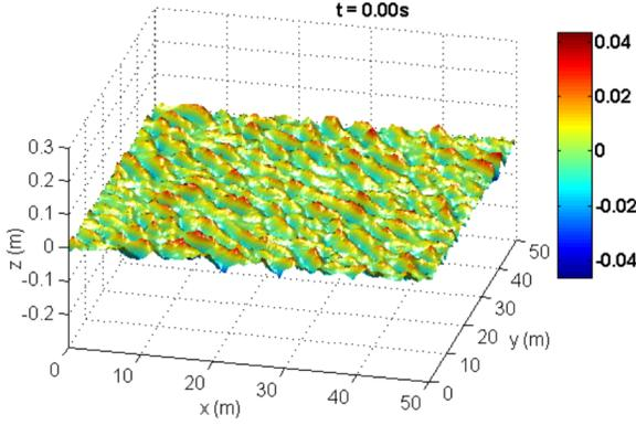
**FIGURE 8.** THE INITIAL CONDITION FOR THE DIRECTIONAL IRREGULAR WAVE SIMULATION.
