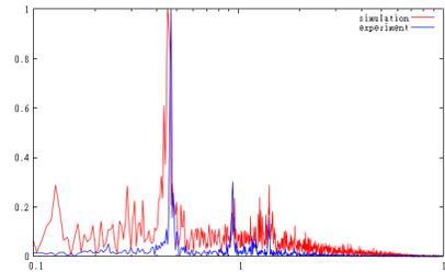
**FIGURE 7.** EXPERIMENT vs SIMULATION: SPECTRUM OF THE WATER HEIGHT IN THE MIDDLE OF THE MOONPOOL. NOTE THAT THE RESONANCE FREQUENCY IS QUITE NICELY CAUGHT IN THE SIMULATIONS.
