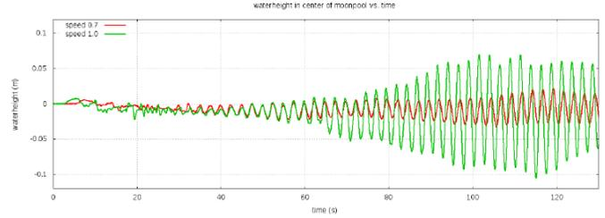
**FIGURE 6.** WATER HEIGHT AS A FUNCTION OF TIME FOR THE TWO FINAL SPEEDS (AFTER ACCELERATION) IN THE SIMULATION. FOR THE WATER MOTION AT FINAL SPEED 1.0m/s RESONANCE BEHAVIOUR IS OBSERVED.
