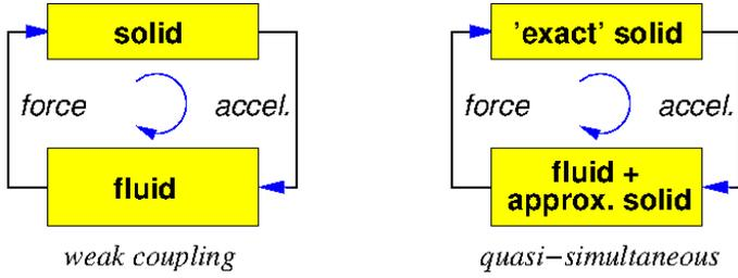
**FIGURE 3.** WEAK VERSUS QUASI-SIMULTANEOUS COUPLING.
