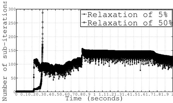
**FIGURE 7.** TIME HISTORY OF NUMBER OF SUB-ITERATIONS REQUIRED TO ACHIEVE CONVERGENCE PER TIME STEP
