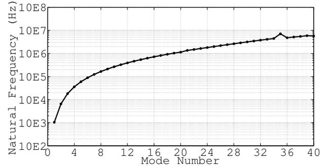
**FIGURE 9.** ALL NUMERICALLY COMPUTED DISCRETE BEAM NATURAL FREQUENCIES
