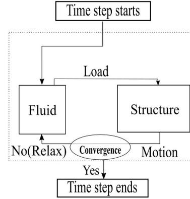
**FIGURE 2.** THE SCHEMATIC VIEW OF DIRICHLET/NEUMAN ITERATIVE PROCEDURE.
