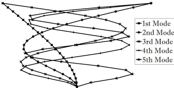
**FIGURE 8.** FIRST FIVE NUMERICALLY COMPUTED BEAM MODE SHAPES
